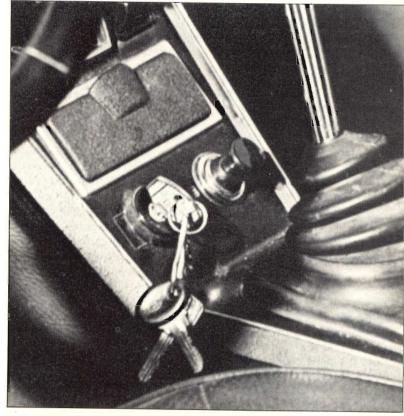
Il connettore consiste in una femmina da pannello ed un maschio asportabile, che in origine era collegato ad un grosso cavo multifilare. Orbene il nostro amico ha fatto in modo che i vari punti di tutto l'impianto elettrico della macchina facessero capo a diversi contatti sul connettore e i relativi collegamenti tra loro fossero sul maschio. Risulta ora evidente che asportando il maschio, ben poco poteva funzionare, a meno che
