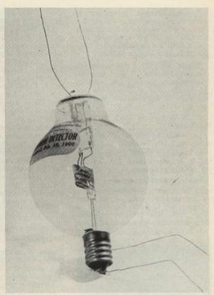
Lee de Forest (1873-1960) è l'inventore dell'« audion », ossia del triodo, il primo tubo amplificatore ed oscillatore. Nelle immagini in alto de Forest e l'« audion ». A destra, interno della stazione radio trasmittente di Carnavon (Galles) realizzata nel 1921. Le 30 valvole erano montate in parallelo per raggiungere la potenza desiderată.
