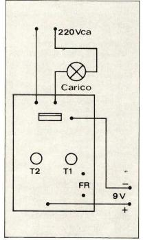
Schema di principio delle connessioni da effettuare rispetto al carico ed alla sorgente di alimentazione.
