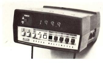
L'ultima novità della gamma in continua espansione di strumenti della Fluke è rappresentata da un nuovo multimetro digitale che crediamo sia il primo strumento numerico a 3-1/2 cifre che permetta di misurare le tensioni e correnti efficaci vere in C.A., come pure di provare diodi.
