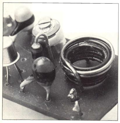
Oltre che per le gamme VHF questo circuito si presta bene anche per funzionare sulla gamma CB con l'avvertenza di sostituire i condensatori e la bobina del circuito oscillante come consigliato più avanti.
