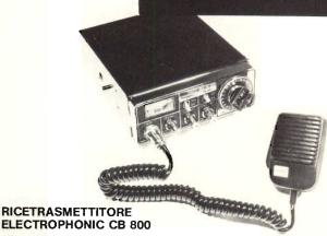
23 canali quarzati - Completo di microfono - Prese per microfono, antenna ed altoparlante esterno - Indicatore S/RF - Controllo volume e squelch - Sintonizzatore Delta Tuning - Commutatore PA/CB - Potenza stadio finale 5 Watts - Sensibilità 0,7 uV per 10 dB - Alimentazione 13,8 Vc.c. Prezzo L. 103.000
