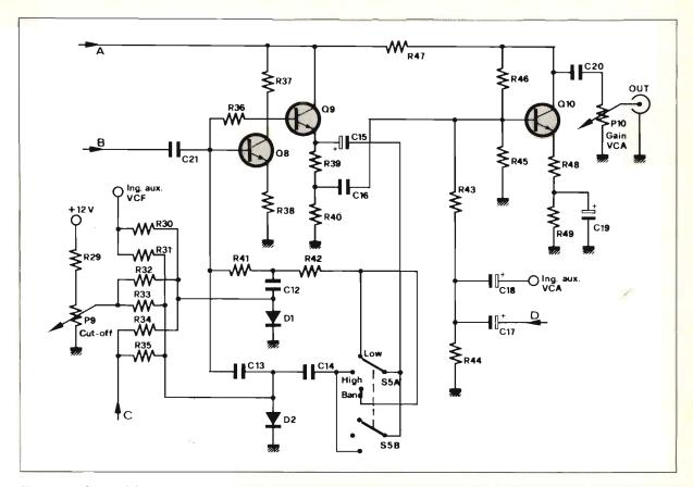
Nei due schemi elettrici è rappresentata l'intera struttura elettrica del sintetizzatore per la produzione di effetti musicali elettronici. I punti di unione fra i due schemi sono contraddistinti dai riferimenti A, B, C, D. A destra, nella foto, alcune delle prove nel nostro laboratorio.
