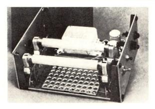
Nell'immagine un esempio di struttura realizzata per mantenere costanti, da una volta all'altra, le condizioni fisiche a cui si opera per ottenere la fotoincisione delle basette ramate.
