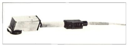
Gli strumenti costruiti dalla TRANS-MET sono particolarmente adatti per la rivelazione ed il controllo della temperatura superficiale di nastri, rulli, fibre e fili in movimento sia allo stadio di ricerca che durante il processo di produzione.
